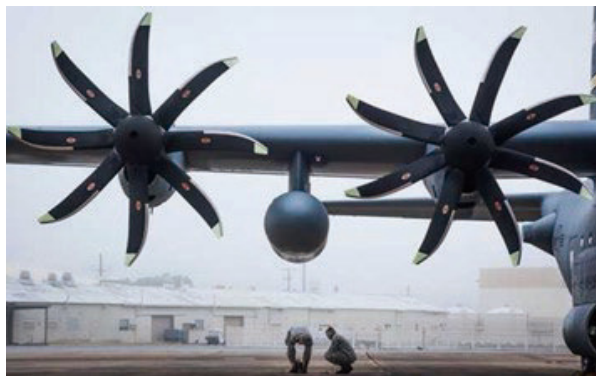
图2 C-130H上的NP2000系列8叶螺旋桨 Fig. 2 NP2000 series 8-blade propellers on C-130H
