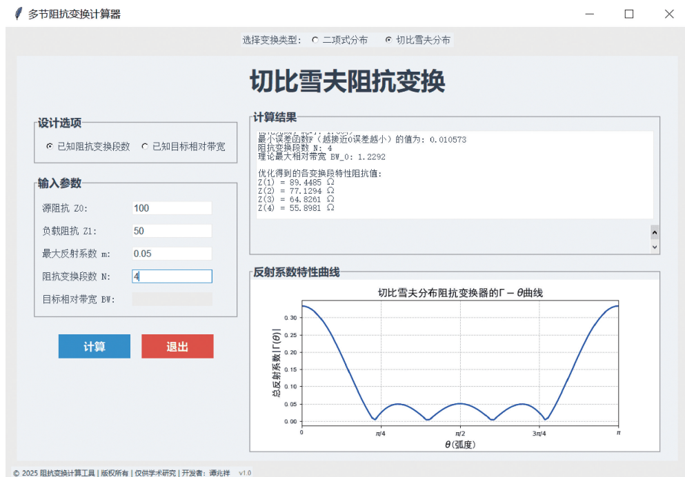
图4 切比雪夫阻抗变换器程序运行界面及结果
