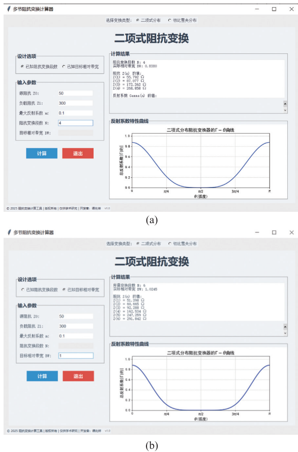
图2 二项式阻抗变换器程序运行界面及结果 (a) “已知变换段节数”模式；(b) “已知目标相对带宽”模式
