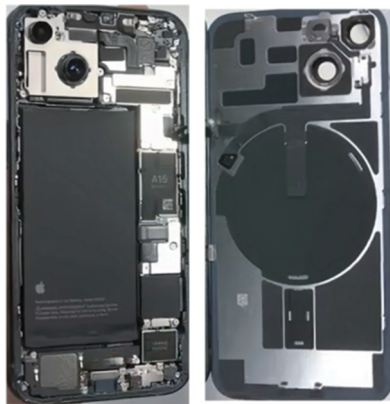
图2 iPhone 14 手机背面拆机图
