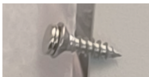
图8 磁片贴于螺丝钉底部
