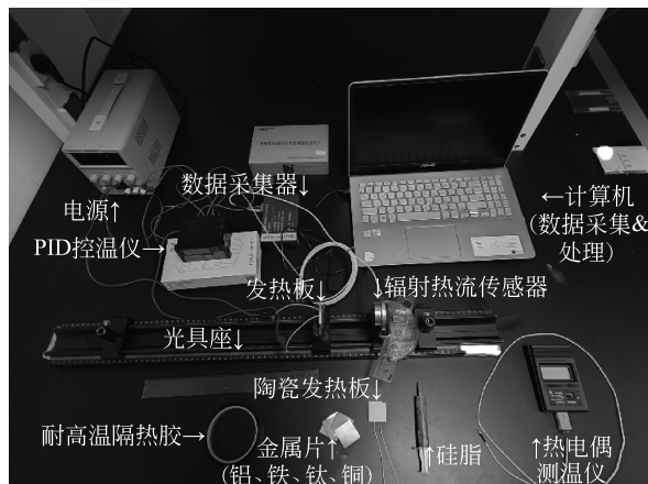
图 2 热辐射综合实验平台装置实物图
