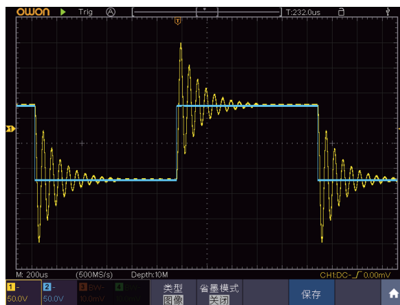
图 2 RLC 电路在欠阻尼状态下电容电压的振荡
