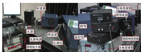
图4 透射光谱实验装置图
