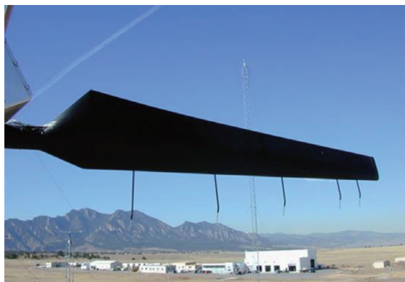
图 12 IEA 任务 14/18 中的外场实验图 (采用探针测量入流角) [86]
